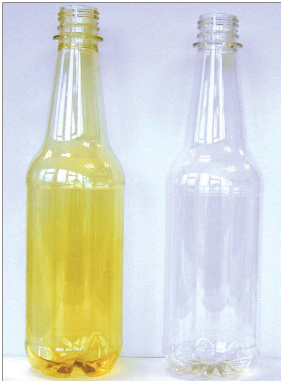
Braunfärbung durch Innenbeschichtung mit Kohlenstoffverbindung im Vergleich zur SiO 2 -Beschichtung.
