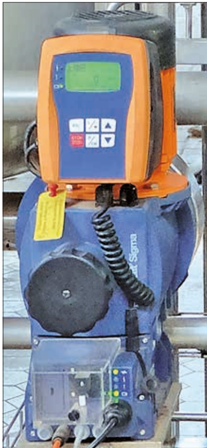
Abb. 6: Industrie-Membranpumpe zum Einsatz im Lebensmittelbereich
