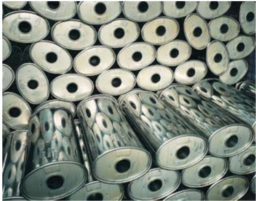
Auspuffanlagen – ein Einsatzgebiet von ferritischem nichtrostendem Stahl im Automobilbau
