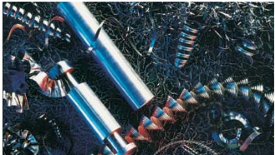
Bild 7: Beispiele von Spanausbildungen bei unterschiedlichen Schwefelgehalten
